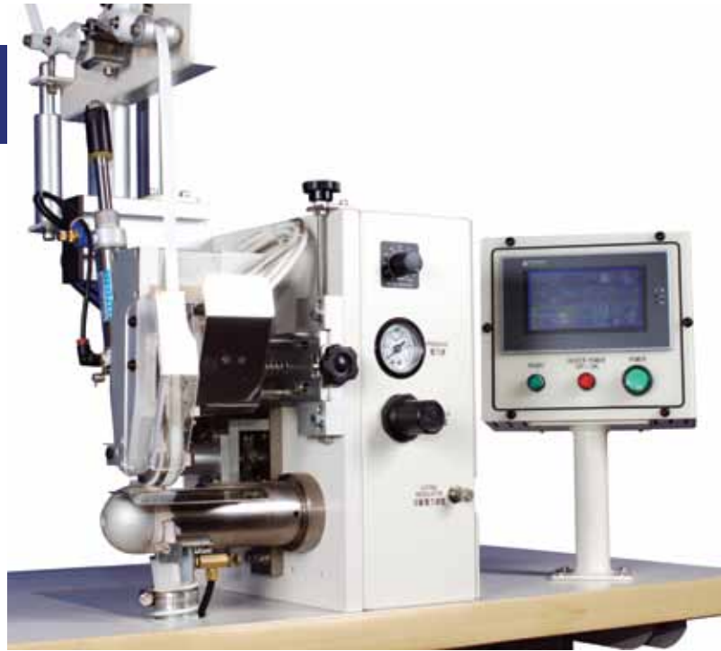
KHA-850K - Aplicação de fita adesiva, refilando excesso de material.
