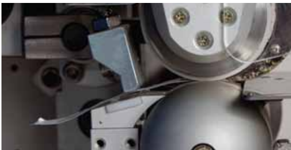
Cilindros superior e inferior para transporte do material, com ajustes de velocidades. Guilhotina para corte da fita ao final do processo.
