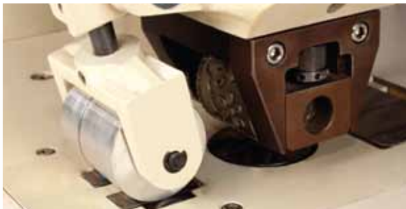
Catraca Auxiliar para transporte do material.
