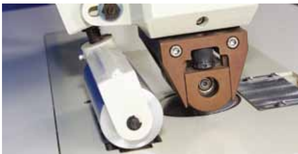
Catraca Auxiliar para transporte do material.
