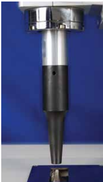
Rolete inferior com até 15 mm de largura e Horn superior localizado 20 mm acima da mesa de trabalho.
