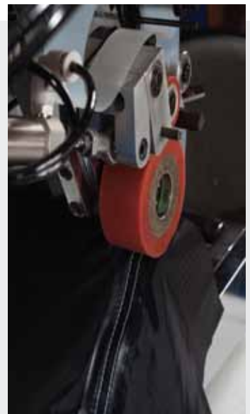
Operação de Acabamento em Capa de Chuva - Roupas para Motoqueiro selando costura pré-existente.
