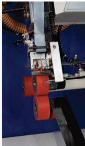
Posição de trabalho para selagem de peças cilíndricas ou curvas.
